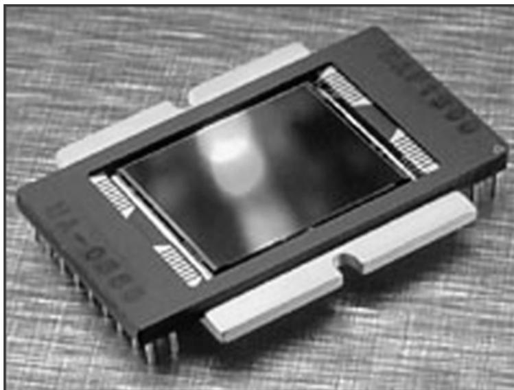
Figura 1.3: Questo CCD della Kodak è tipico dei sensori d'immagine che si trovano in molte macchine digitali.
