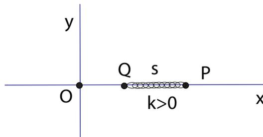
Il sistema ha un grado di libertà, che descriviamo con la coordinata lagrangiana  $s$ , la distanza con segno di  $P$  da  $Q$ . Indicando con  $\hat{\mathbf{i}}$  il versore dell'asse  $x$  abbiamo, :
