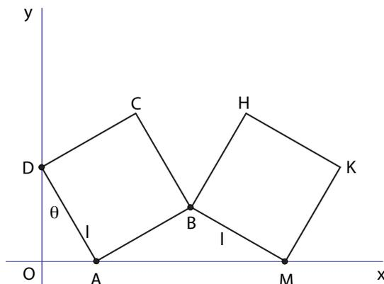
Il sistema ha un grado di libertà, descritto dall'angolo  $\theta$  che il lato  $AD$  forma con la verticale. Per determinare le traiettorie polari del secondo quadrato, usiamo la formula fondamentale dei moti rigidi scritta per il centro istantaneo di rotazione, che indichiamo con  $Q$ . Siano inoltre  $x$  ed  $y$  le coordinate di  $Q$  nel sistema fisso indicato in figura. Avremo allora
