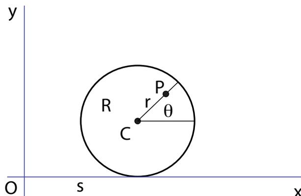
Il sistema ha un grado di libertà, in quanto il vincolo di rotolamento puro è un vincolo integrabile. Se indichiamo con  $s$  l'ascissa del centro  $C$  e con  $\theta$  l'angolo di rotazione (come in figura), abbiamo
