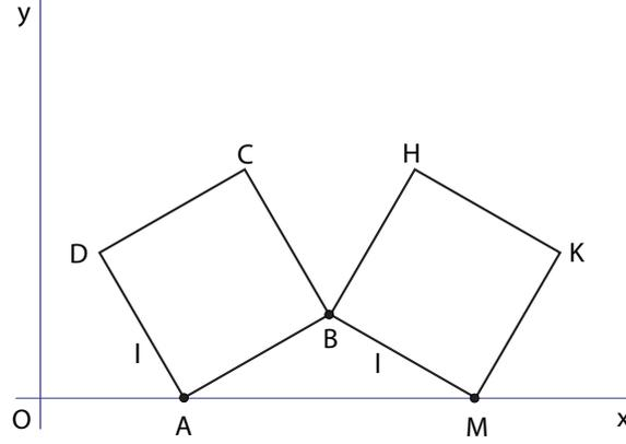
Il sistema ha zero gradi di libertà, in quanto il suo moto è univocamente determinato dai dati del problema. Indichiamo comunque con  $\theta$  l'angolo che il lato  $AB$  forma con l'asse  $x$ . Per determinare le traiettorie polari del secondo quadrato, usiamo la formula fondamentale dei moti rigidi scritta per il centro istantaneo di rotazione, che indichiamo con  $Q$ . Siano inoltre  $x$  ed  $y$  le coordinate di  $Q$  nel sistema fisso indicato in figura. Avremo allora
