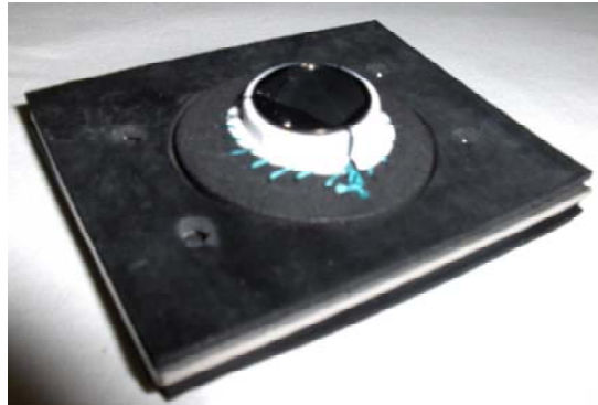
Figura 3.6 – Valvola della SulzerMedica ® , riportata in figura 2.1, suturata dal dr. Coletti su uno spessore di gomma.
