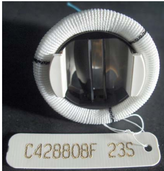
Figura 2.1 – La valvola aortica meccanica inserita nel banco prova: la sezione interna è di 23 mm. La valvola è stata fabbricata da SulzerMedica®.
