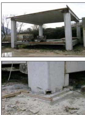
Struttura a Base Fissa (BI)
