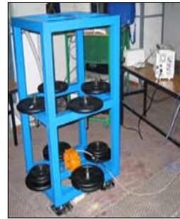
Fig. 12 – Calibrazione del sistema di isolamento
