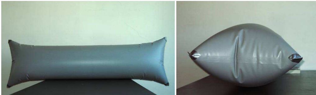
Figura 9: modello sperimentale di airbag rettangolare in PVC rinforzato da fibre in poliestere; vista dall'alto (a sinistra); vista laterale (a destra).
