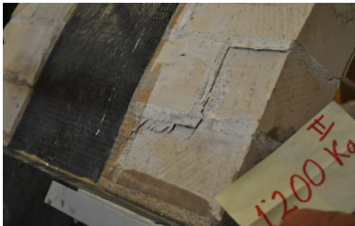
Figura 9- II Ciclo, IV cerniera: Scorrimento a taglio del giunto 1. Effetto spinotto solo nella larghezza efficace. Fessure trasversali al di fuori della fascia.
