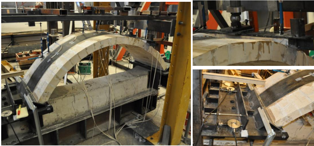
Figura 6- Foto dell'apparato di prova sull'arco con rinforzo estradosso in FRP
