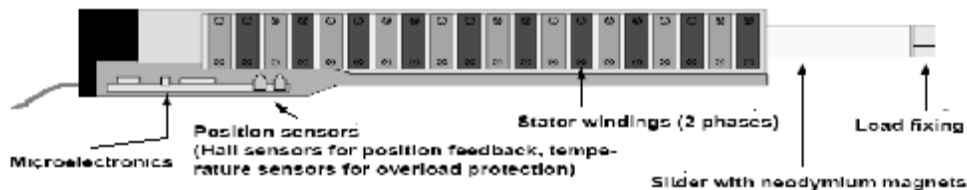
Figura 3: Il motore lineare tubolare utilizzato nel banco prova.
