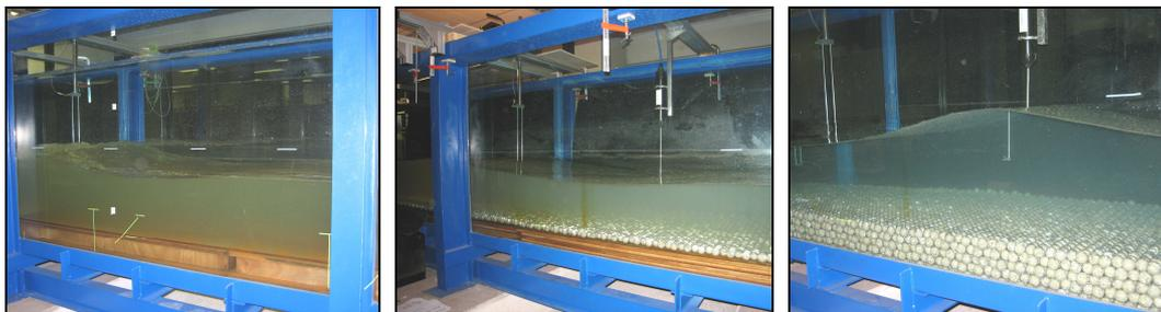
Figura 2: Configurazione di fondo impermeabile liscio (sinistra), impermeabile scabro (centro) e permeabile (destra).
